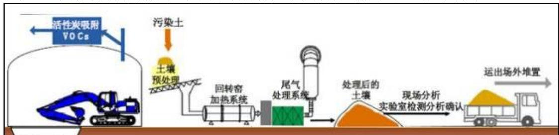
图 4.1- 2 热脱附技术原理图
